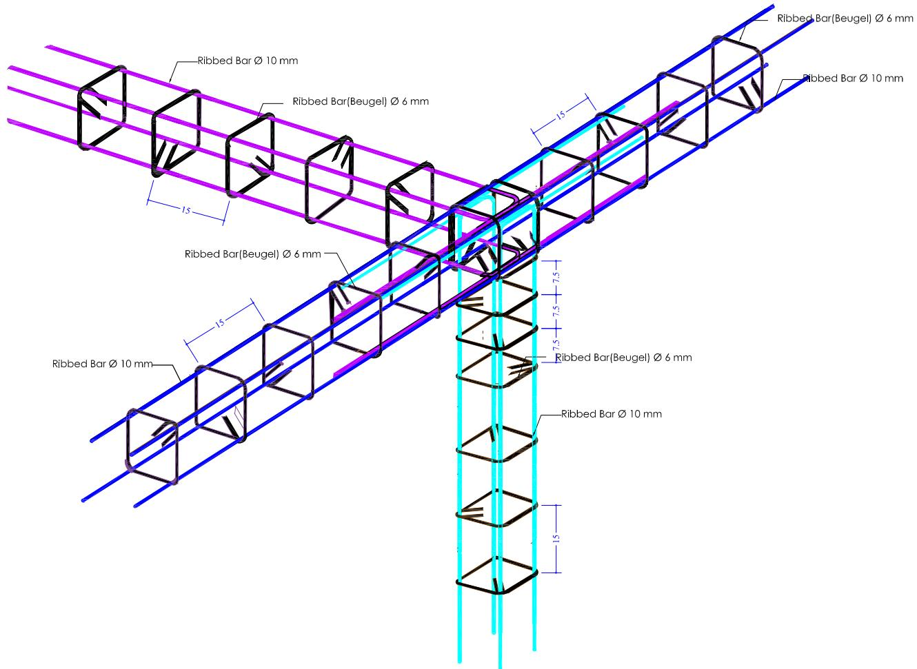
Pembesian Tiga Dimensi Ring Balok (Detail Pada T) Menggunakan Besi Ulir
