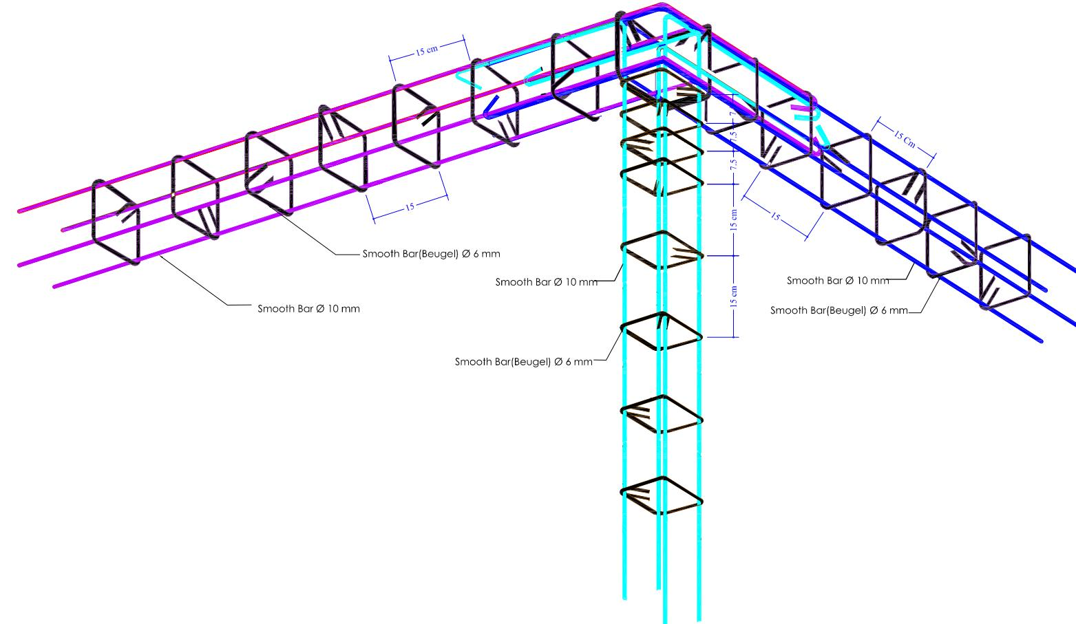
**Pembesian Tiga Dimensi Ring balok ( Detail Pada Sudut) Menggunakan Besi Polos**
