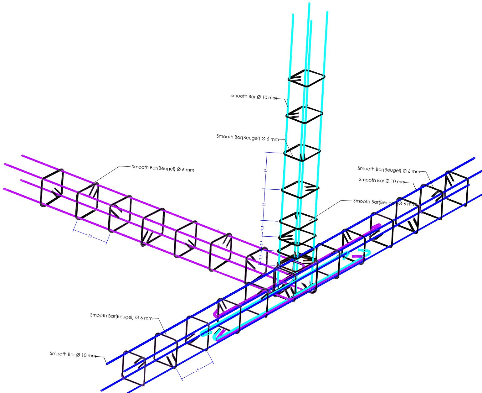
Pembesian Tiga Dimensi SLOOF ( Detail Pada T ) Untuk Besi Polos
