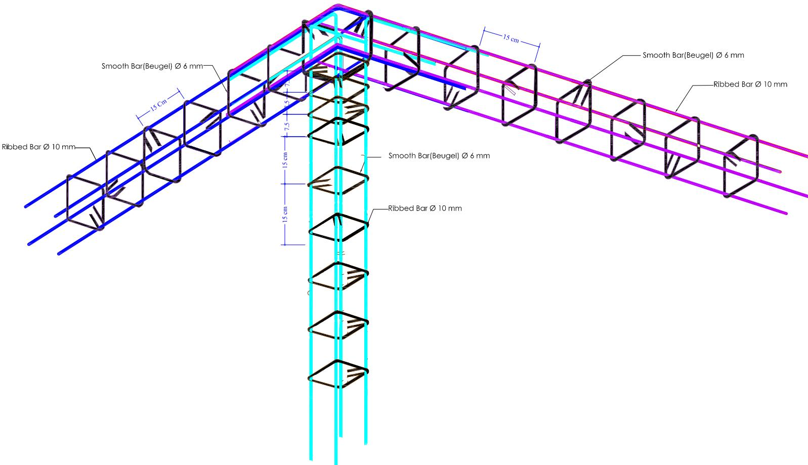
**Pembesian Tiga Dimensi Ring balok ( Detail Pada Sudut) Menggunakan Besi Ulir**
