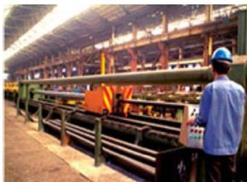
冷轧钢筋CRB直径一般在 $4\text{mm} \sim 12\text{mm}$ ，带有月牙肋，按强度可分为CRB550, CRB650, CRB800等。
