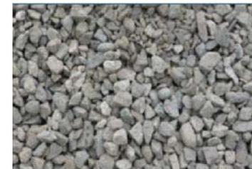
碎石粒径：砖混结构中粗骨料碎石粒径 $>5\text{cm}$ 时，会影响与混凝土的粘接，因此建议可使用碎石最大粒径为4cm。
