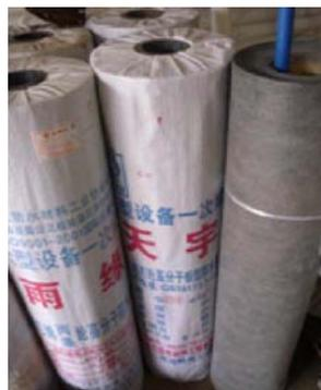
无纺布易分层，使用寿命短，是防水材料里的低档产品
