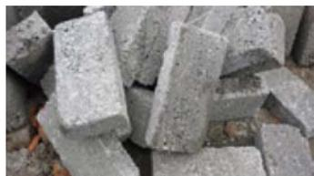
混凝土空心砖：强度略低，用于非承重结构的填充墙体，起到一定的隔音和保温作用，且与砂浆的粘结力差，不能用于承重墙体。
