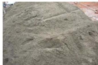
天然砂包括河沙、海砂, 粒径光滑, 与水泥粘接不如人工砂
