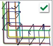
最好的方式: 8根钢筋全锚固 到外筋上。
